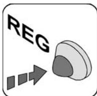
Bei der Ausführung GSR 36 E mit eingebautem Enthärter (SoftMatik) signalisiert das Aufleuchten der „REG“-Anzeige (6) einen Salzmenge im Salzlösebehälter.
